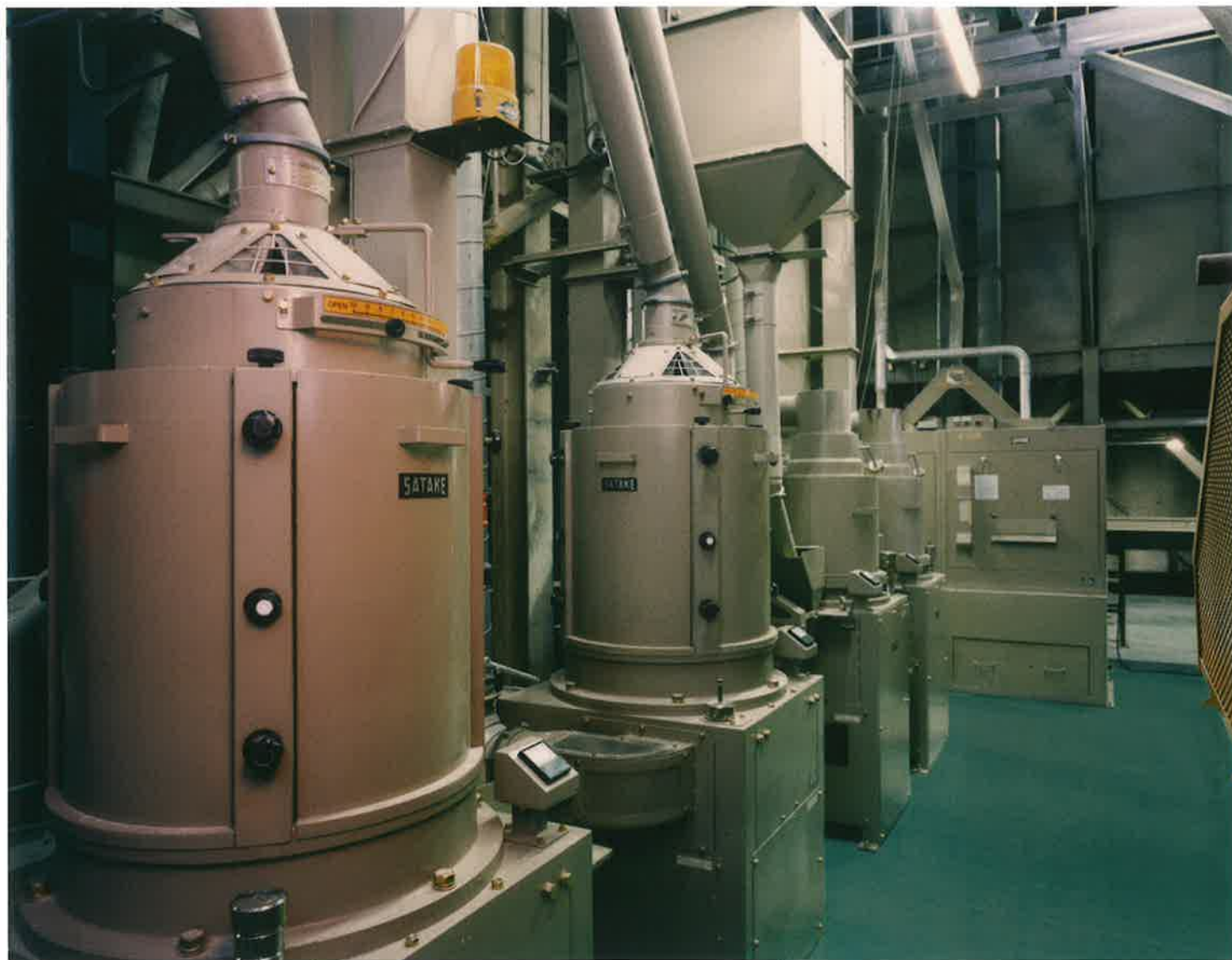
●精米機 [VTA10A×2台・サタケ/VWB5A×2台・サタケ] 高歩留りと製品の水分をコントロールし、顧客ニーズに合わせた精米を行います。
