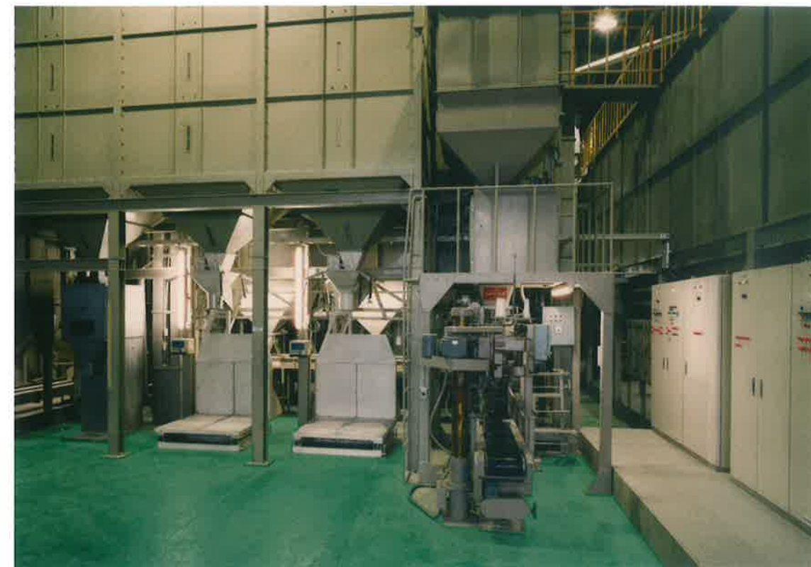
●全自動計量包装機・フレコン自動計量機 [1t計量機×2台] 設定外の計量が行われるとチェッカーが作動してオペレーターに報知。いつも一定した計量が行えます。
